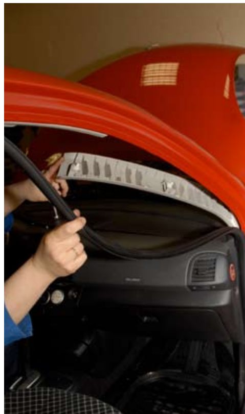
Снимаем накладку правой стойки, потянув ее на себя
