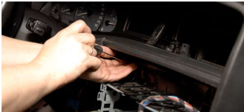
Выкручиваем два оставшихся самореза крепления корзины
