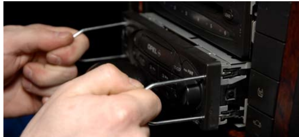
Легким нажатием на ключи ослабляем фиксаторы и вытягиваем головное устройство
