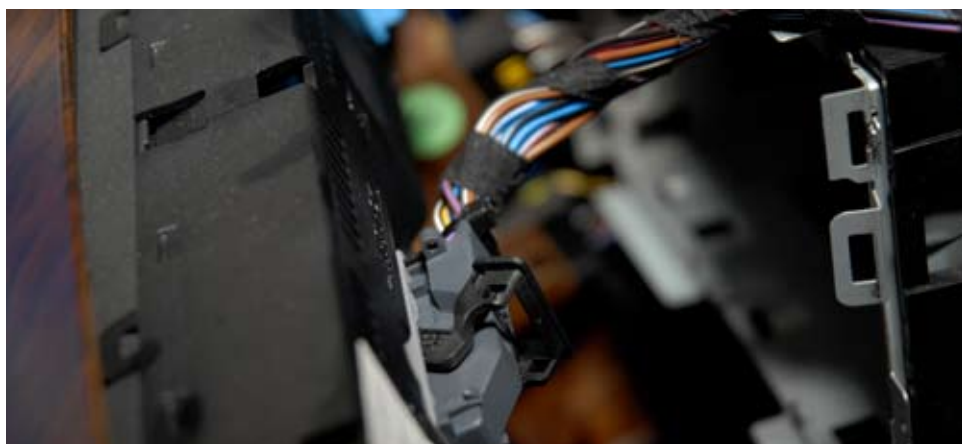
Сдвинув кожух вперед, отстегиваем два разъема
