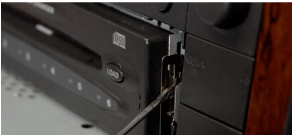
Тонкой шлицевой отверткой отжимаем фиксаторы CD-ресивера
