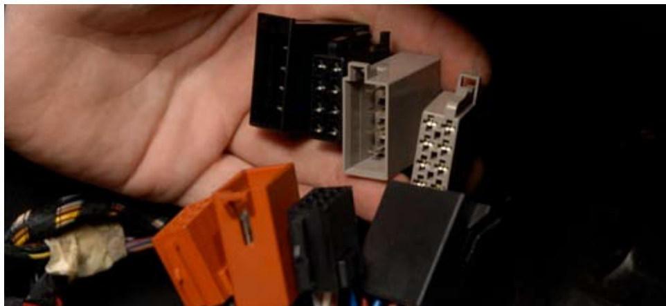
Подключаем ISO-разъемы интерфейсного кабеля к ISO-разъемам кабеля Parrot
