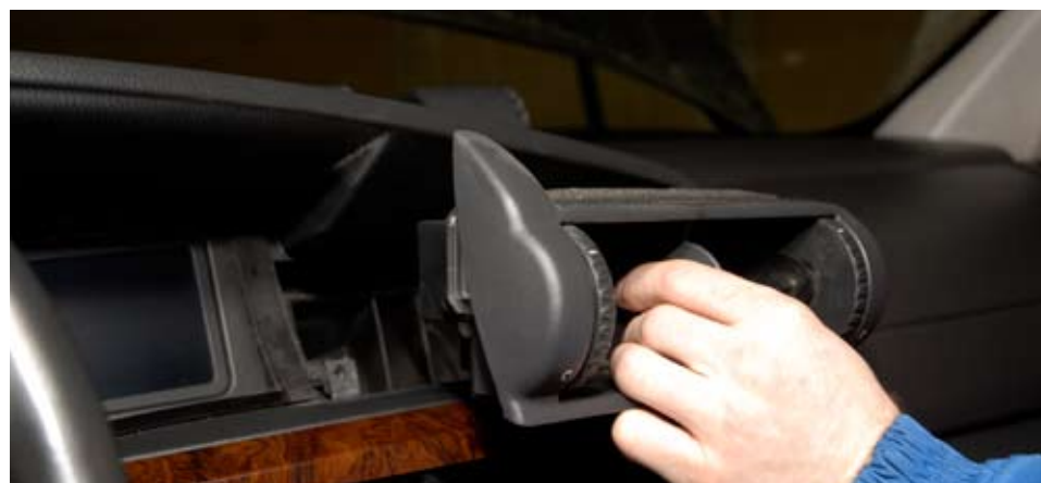
и вынимаем основание дефлекторов
