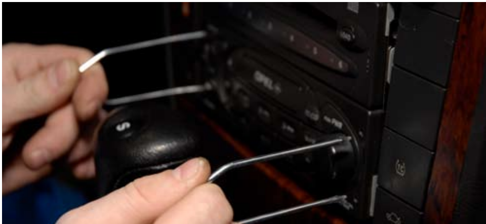
Вставляем ключи-съемники в пазы головного устройства
