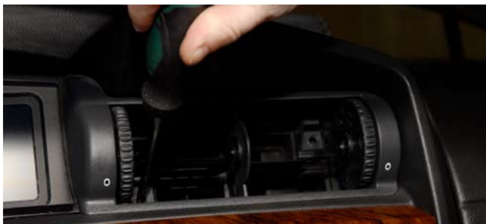
Откручиваем саморезы крепления
