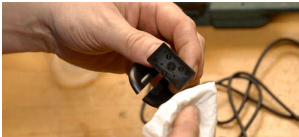
Обезжириваем склеиваемые поверхности
