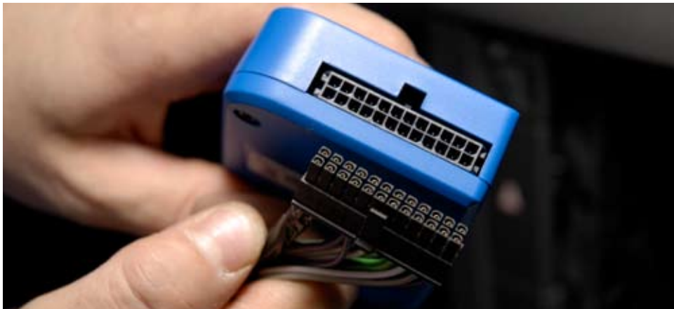
Подключаем кабель интерфейсного кабеля к блоку управления Parrot
