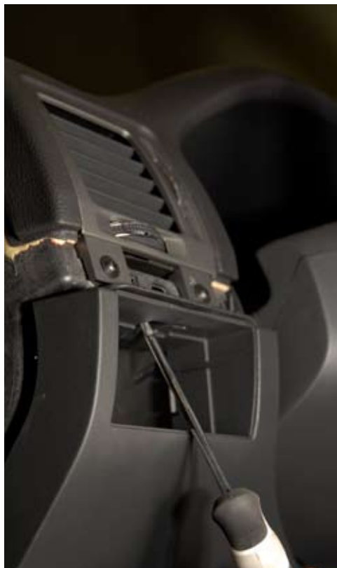
Откручиваем саморез, закрытый блоком регуляторов света
