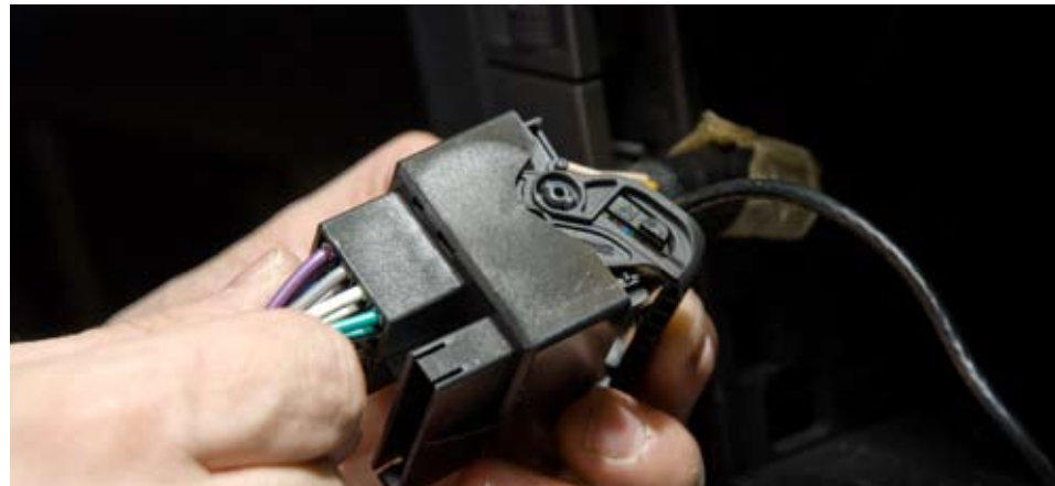
Подключаем интерфейсный кабель 86172 к нему
