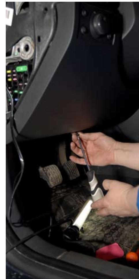
Откручиваем три самореза крепления нижнего элемента торпедо
