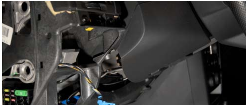
Из-за недостатка места в нише головного устройства, блок управления был установлен под рулем, длины кабелей более чем достаточно
