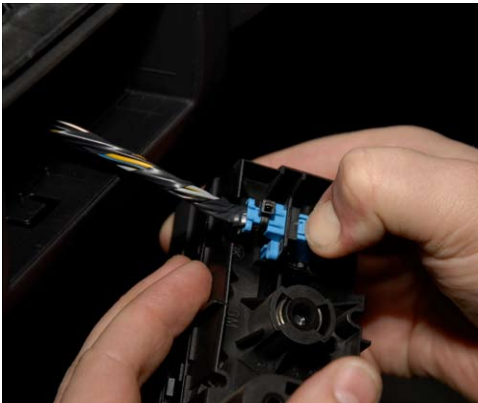
Вынимаем разъем блока регуляторов света и окончательно снимаем блок
