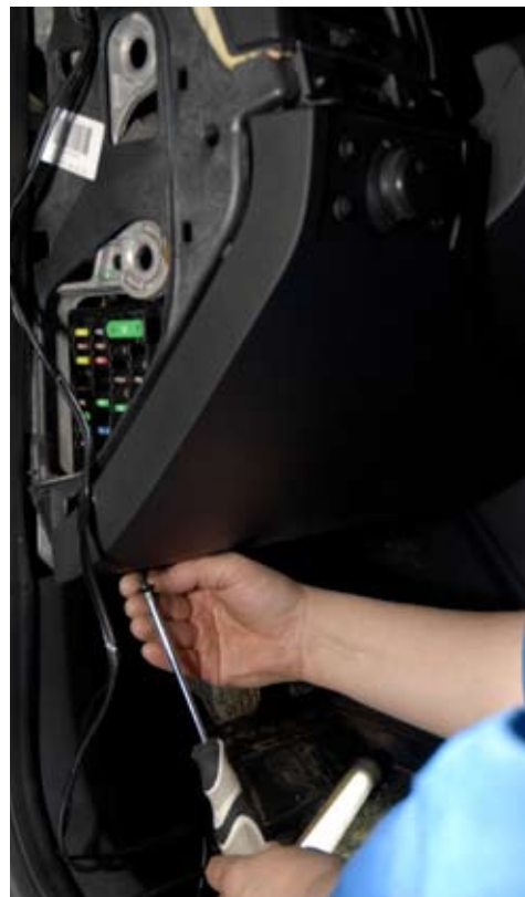
Откручиваем три самореза крепления нижнего элемента торпедо
