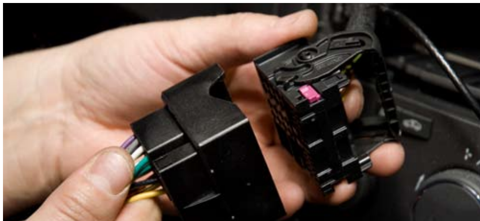
Находим ответную часть в кабеле 86172
