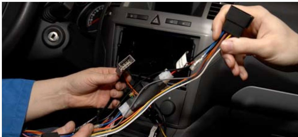
Подключаем кабель 86172 к кабелю комплекта Parrot
