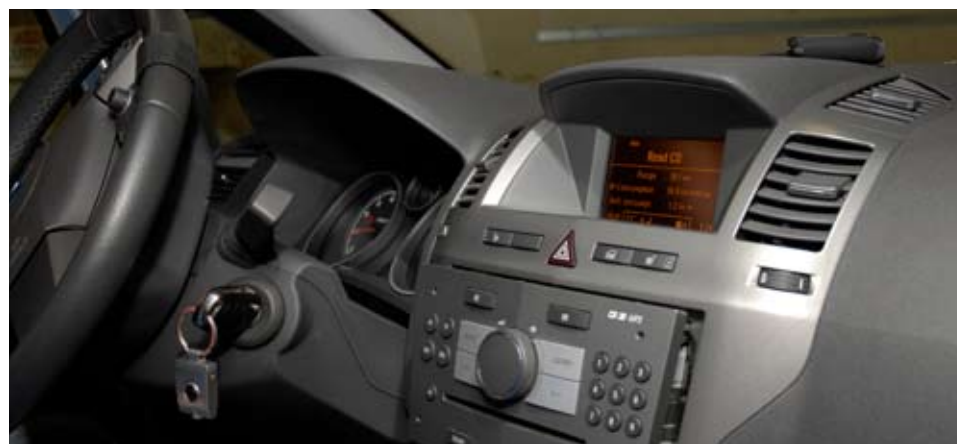
Подключаем клемму «-» и проверяем работу устройств при включенном зажигании
